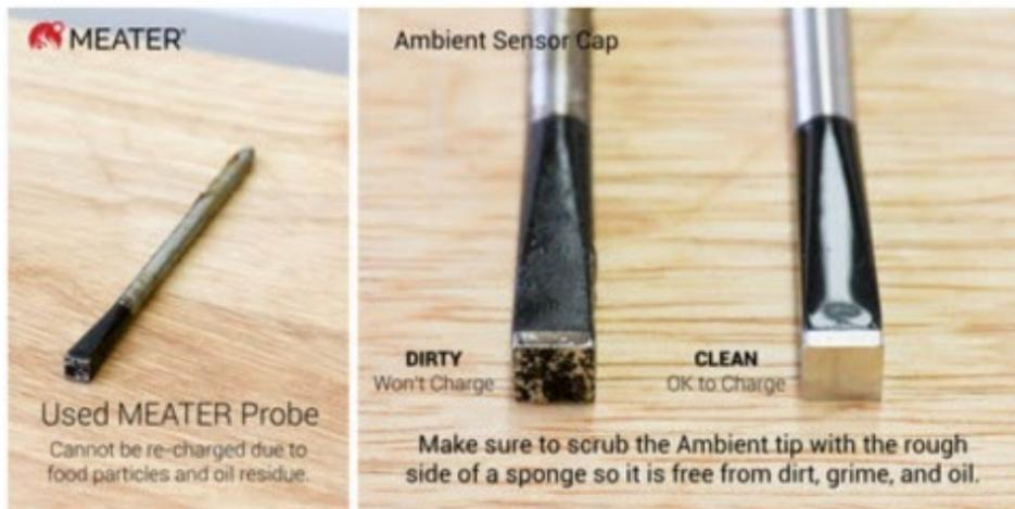
Untersuchen Sie die Sonde auf eventuelle Schäden. Prüfen Sie, ob irgendein Teil der Sonde wackelt oder sich drehen kann, insbesondere das quadratische Ende der Sonde oder die Dichtung zwischen der schwarzen Keramik und dem Stahlschaft. Wenn Sie die Sonde genau untersuchen, gibt es Haarrisse in der schwarzen Keramik?
