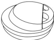
Schneidrotor mit „Abweiser“
