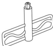
Couvercle avec mécanisme de rotation
